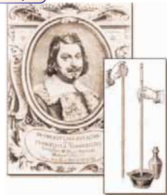
Εικόνα 4.15. Εβανγκελίστα Τορικόλι (Evangelista Torricelli) (1608-1647). Σχεδιάγραμμα της συσκευής που χρησιμοποίησε για τη μέτρηση της ατμοσφαιρικής πίεσης.
