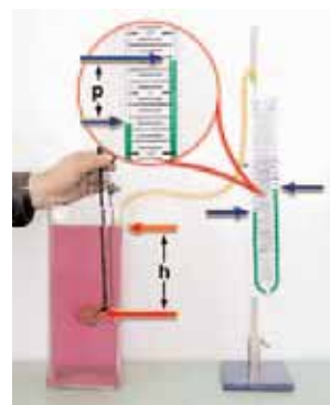
Εικόνα 4.8. Η επιφάνεια βρίσκεται σε βάθος h και είναι: (α) οριζόντια, (β) κατακόρυφη.
