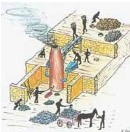
Κάμινος τήξης μεταλλεύματος. (Αναπαράσταση: Κ. Κονοφάγος.)
